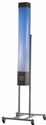
Рециркулятор предназначен для обеззараживания воздуха помещений I-V категорий объемом до 75 куб. м в лечебно-профилактических учреждениях в присутствии и отсутствии людей с помощью обеззараживания воздушного потока в процессе его принудительной циркуляции через корпус, внутри которого размещены две бактерицидные лампы низкого давления 30 Вт
